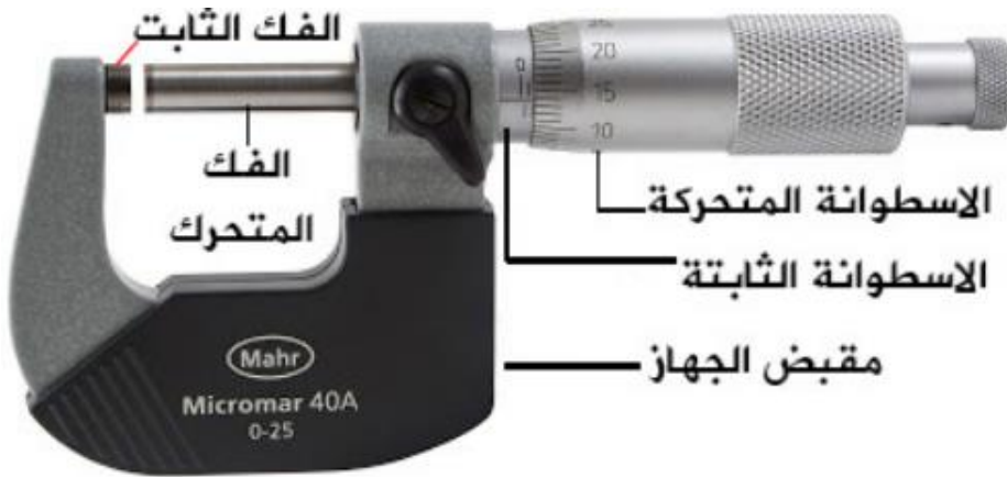
شكل رقم ٧٩: تركيب الميكروميتر
