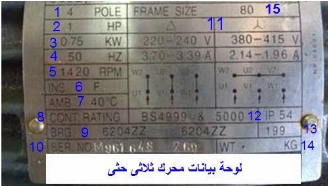
شكل رقم ٤٣: لوحة بيانات محرك حثي ثلاثي الأوجه
