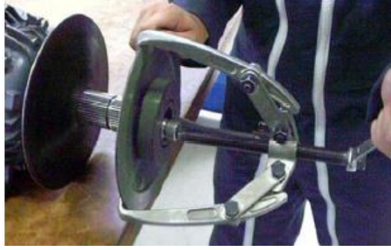
شكل رقم ٤٧: سحب البكرة باستخدام الزرجينة
